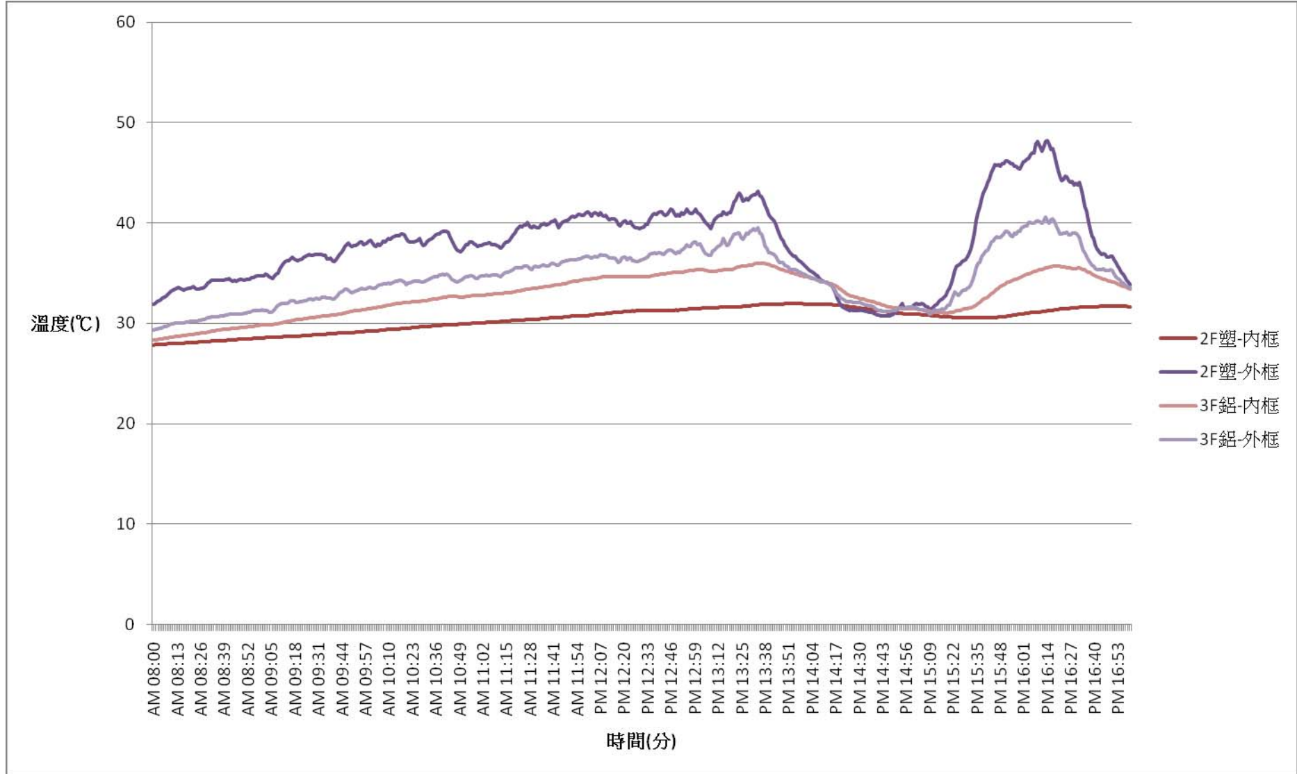
圖 56 20090815 塑鋼窗框與鋁金屬窗框內外表面溫度變化圖
